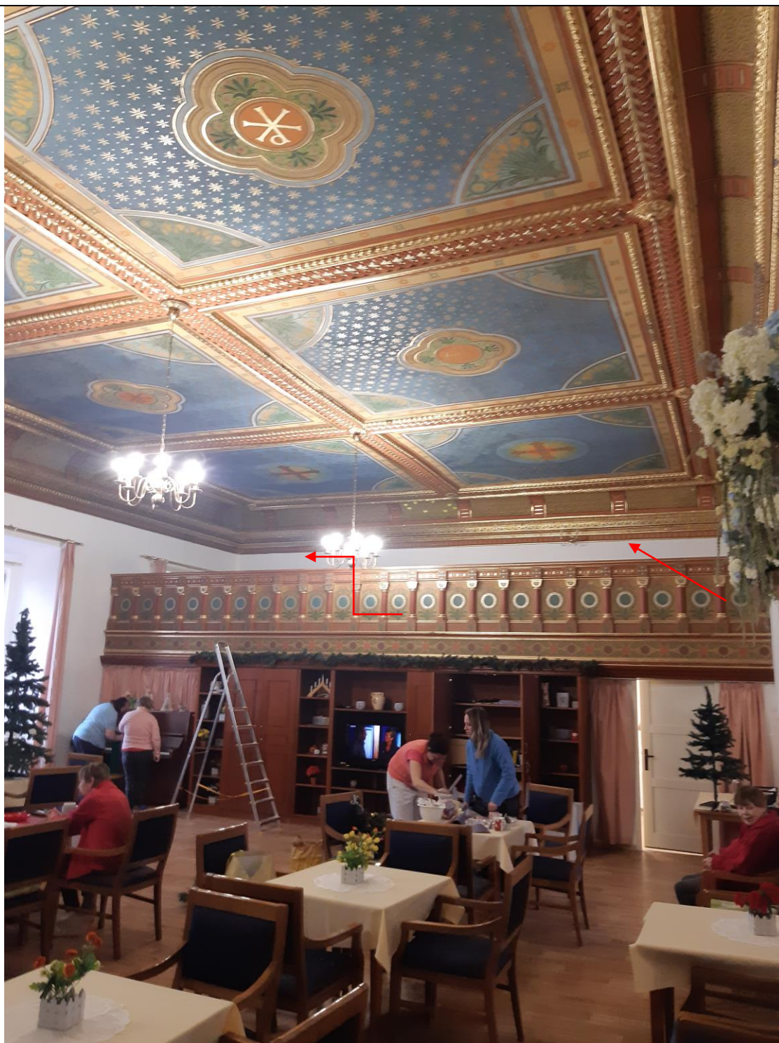
Obr. P1-2 — zde bude prostor pokryt 2ks lineárními hlásiči umístěnými na zeď v ochozu sálu ve 2.NP
